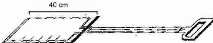
Abb. 4: GÖRBING-Spaten mit flachem (hier leicht gerilltem), 40 cm langem Spatenblatt
