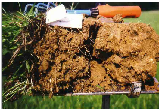
Abb. 1: Beispiel: Verdichteter Lehm Boden
