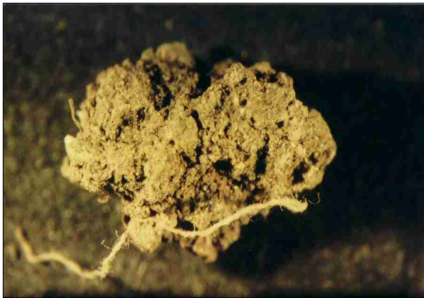
Abb. 3: Aggregierung bei Lehm Böden (zehnfache Vergrößerung, Ø 3mm)
